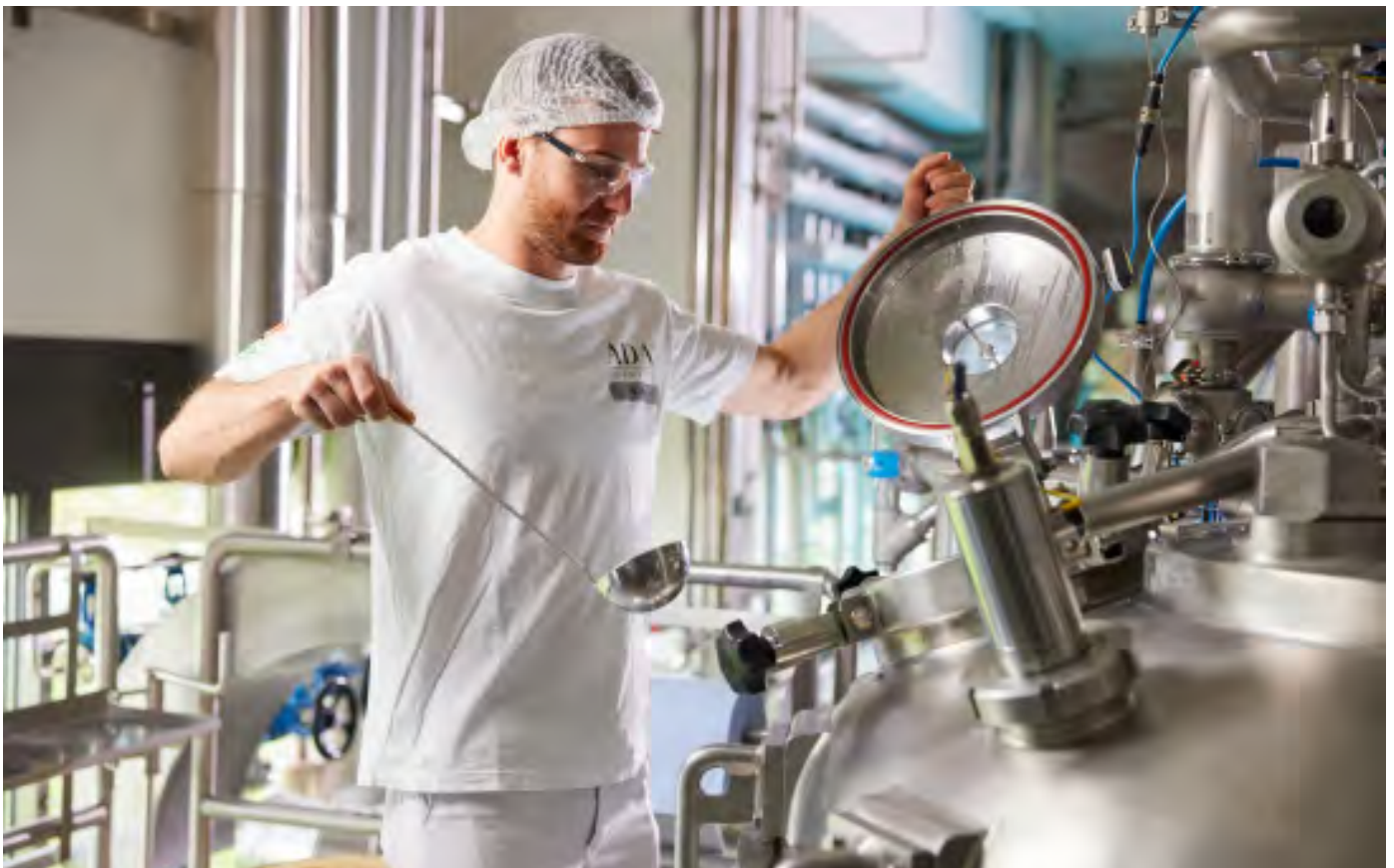
Aufrechterhaltung hoher Qualitätsstandards: Die regelmäßige Entnahme von Proben aus dem Mischbehälter ermöglicht eine kontrollierte Qualitätssicherung während des gesamten Produktionsprozesses.
